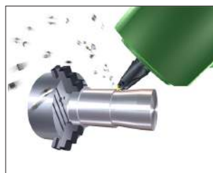
Точение и контурная обработка пластиной DNMG.
