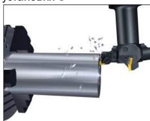
Точение с разворотом фрезерного шпинделя под углом 95°.
