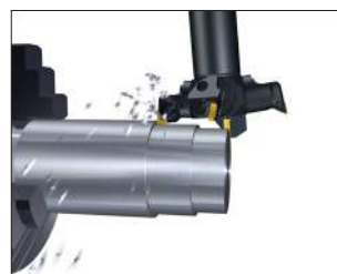
Точение с разворотом фрезерного шпинделя под углом 95°, чтобы режущие кромки головок, не участвующих в работе, не касались заготовки.
