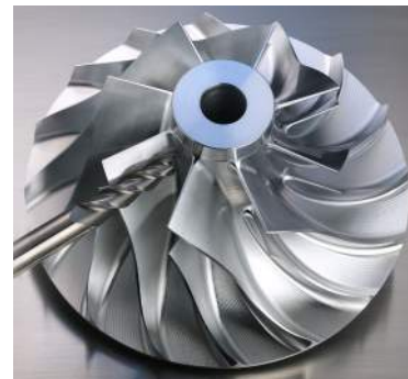
Типичным примером фрезерования закрытых углов является обработка импеллеров.
