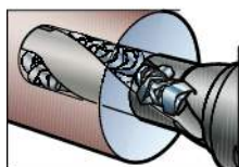
Стружка спрессовывается в канавках
