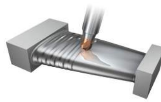
От черного до чистового фрезерования выпуклых и вогнутых поверхностей
