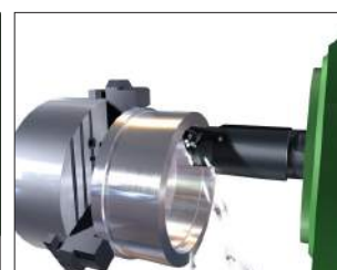
Использование сдвоенного инструмента с разворотом шпинделя под 90° в качестве расточной оправки.
