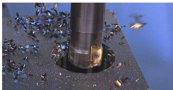
Круговая интерполяция с врезанием для увеличения диаметра отверстия.
