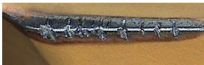
Термические трещины, образующиеся при использовании СОЖ
