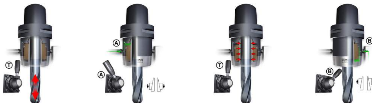
Рукоятка золотника в положении Т при установке и снятии инструмента.
