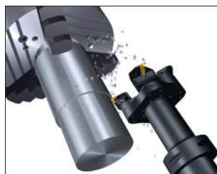
Точение с разворотом фрезерного шпинделя под углом 0°. Хороший вариант для станков с ограниченным перемещением по оси X.
