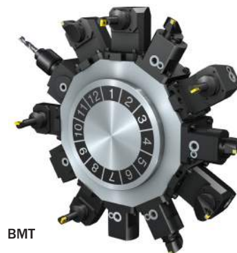
Переоснащение стандартных револьверных головок системой Coromant Capto
