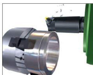
Точение с расположением инструментального шпинделя под углом 0°. Хороший вариант для станков с ограниченным перемещением по оси X.
