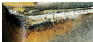
Типичные виды износа пластин
