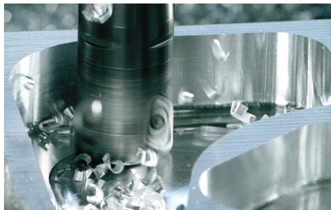
Специализированная фреза CoroMill 790 для обработки алюминия.
