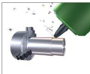
Точение и подрезка торца пластиной CNMG.
